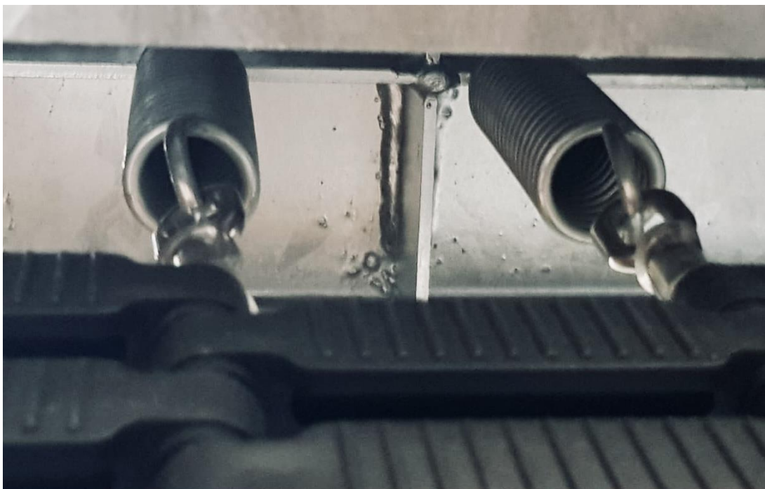
Einbausituation Federn/Matte auf der Sprungmatten-Seite mit Ösen
