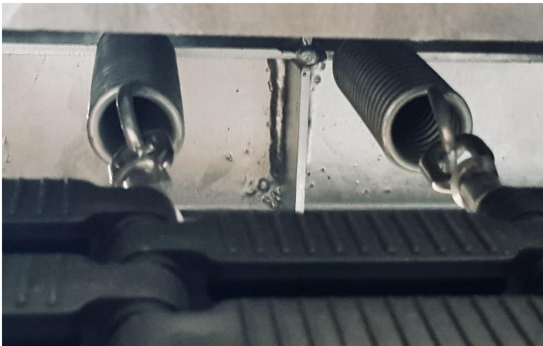
Einbausituation Federn/Matte auf der Sprungmatten-Seite mit Ösen
