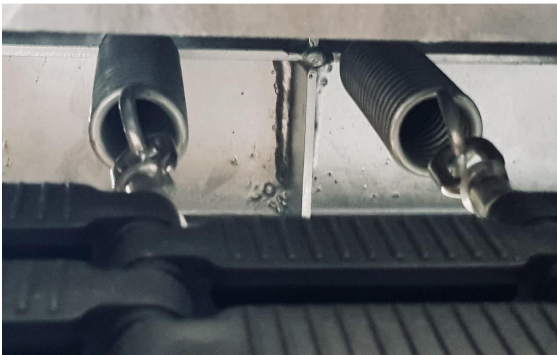
Einbausituation Federn/Matte auf der Sprungmatten-Seite mit Ösen
