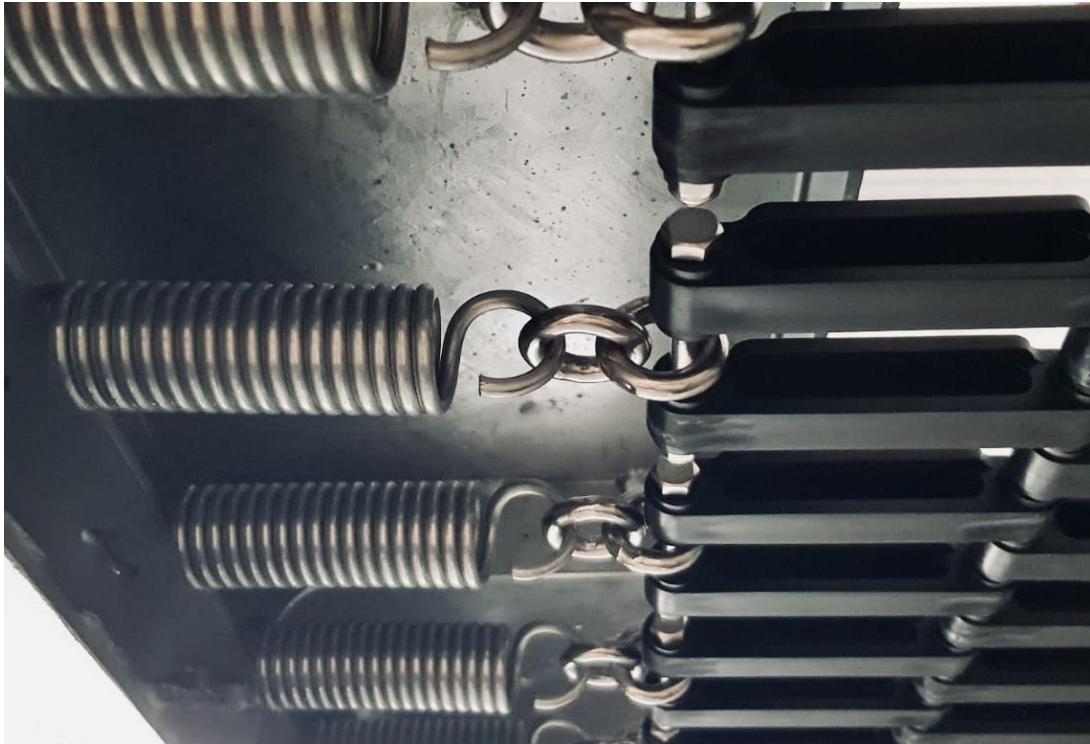
Einbausituation Federn/Matte auf der Sprungmatten-Seite mit Bolzen
