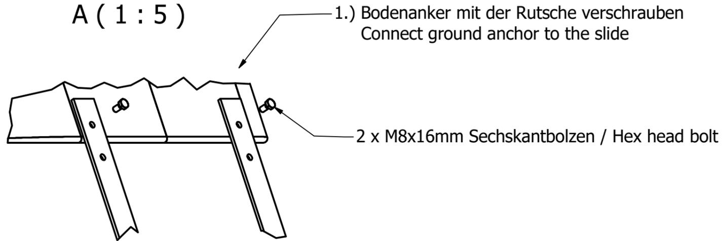
1.) Bodenanker mit der Rutsche verschrauben
